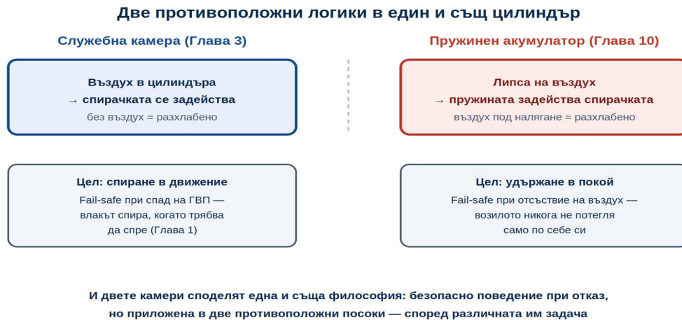
Фигура 10.1 — Служебната камера и пружинният акумулатор споделят философията fail-safe, но в противоположни посоки
