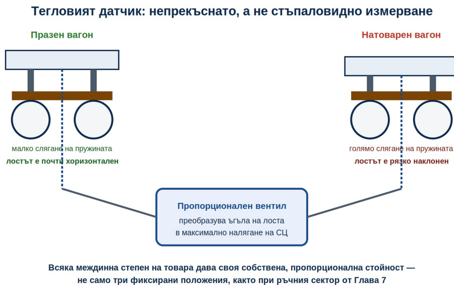
Фигура 12.1 — Тегловият датчик измерва слягането на пружината непрекъснато, а не само в три фиксирани положения
