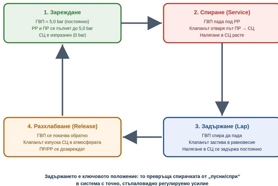
Фигура 5.1 — Четири работни положения на функционния вентил и преходите между тях
