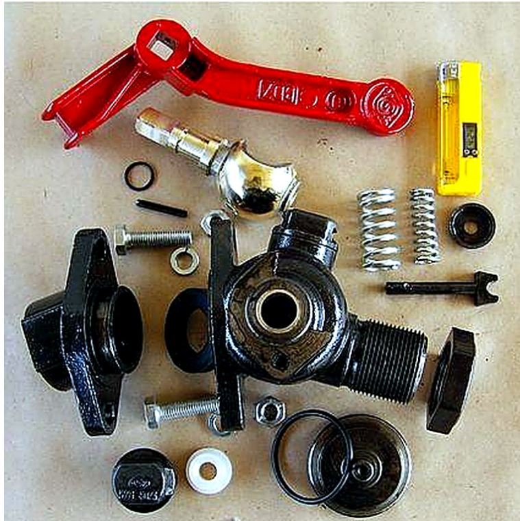
Фигура 13.3 — Разглобените компоненти на LH 3: бронзовата сфера, силиконовите уплътнения, пружинният пакет и заключващата механика на ръкохватката
