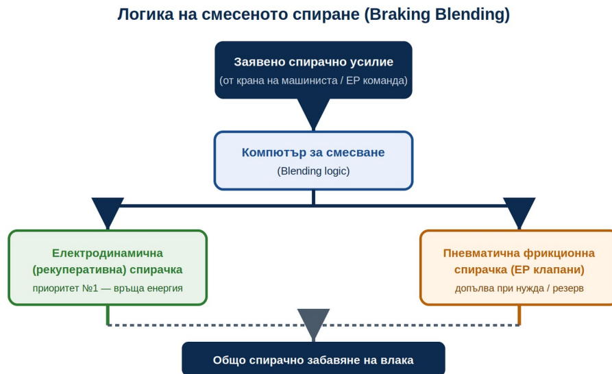
Фигура 4.1 — Логиката на смесеното спиране: компютърът разпределя заявеното усилие между електродинамичната и пневматичната спирачка
