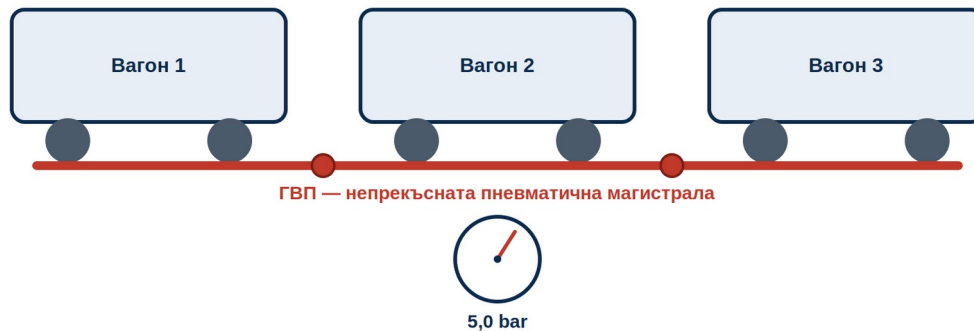
Фигура 1.1 — Главният въздухопровод (ГВП) образува непрекъсната пневматична магистрала по цялата дължина на влака
