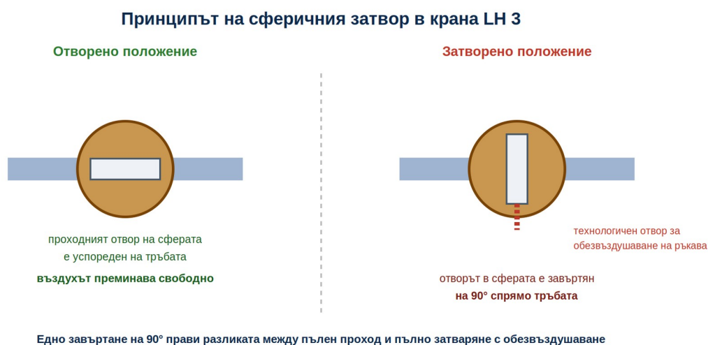
Фигура 13.2 — Принципът на сферичния затвор: 90^{\circ} завъртане между свободен проход и пълно затваряне с обезвъздушаване
