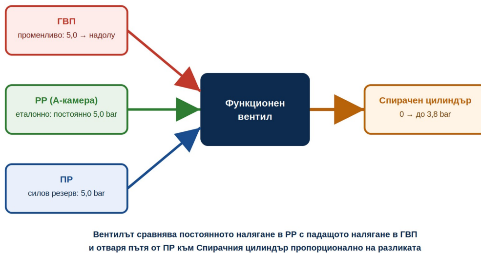
Фигура 2.1 — Пневматичният триъгълник: функционният вентил сравнява ГВП с РР и насочва въздух от ПР към СЦ
